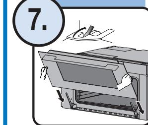
Gerätetur einsetzen, Bügel einklappen
