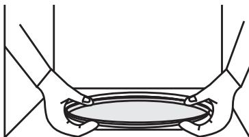
Non dimenticare di ripristinare il dispositivo di movimentazione, il supporto a rotelle e la platea girevole.
